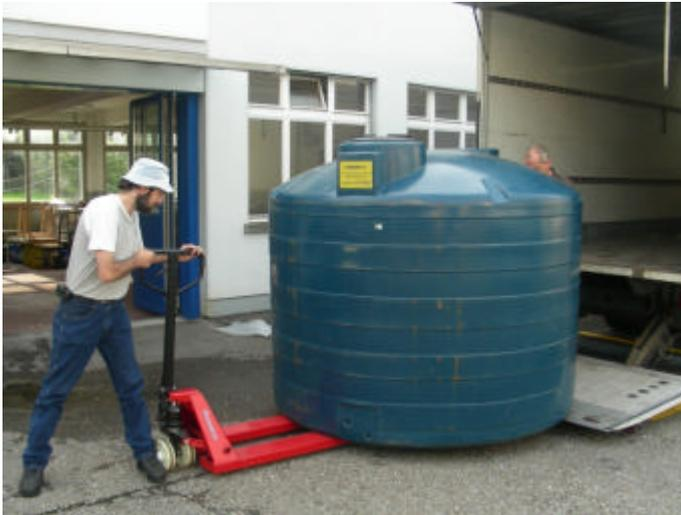
Nachdem das aufgewärmte Öl mit dem Methoxid gut vermischt ist, wird es in den Sedimentationstank gepumpt. In diesem Tank wird das Öl während 24 Stunden zwischengelagert, damit sich der Biodiesel vom Glycerin trennen kann. Das Glycerin senkt sich zum Boden ab, während der produzierte Biodiesel oben aufschwimmt.
