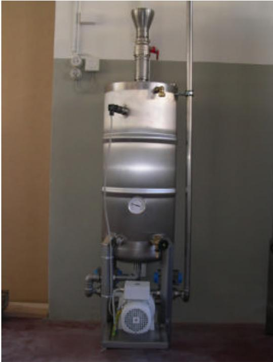
Im Vormischer wird das Kaliumhydroxid, ca 2 kg, im aufgewärmten Methanol, ca 40 Liter, umgerührt und langsam aufgelöst. Dieser Prozess dauert ca 6 Minuten.
