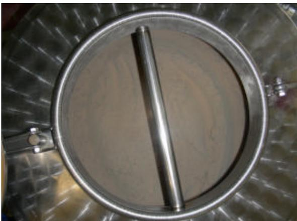
In diesem Prozess sickert der Biodiesel zuerst durch das Lewatit, eine Dicke von einem Meter, und wird anschliessend durch ein sehr feines und engmaschiges Sieb gepresst, damit alle Glycerinrückstände dem Biodiesel entzogen werden kann.
